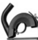
Ochranný kryt odsávání s vodícími saněmi pro rozbrušovací kotouče Ø 180 mm, řezná hloubka 40 mm, připojení Ø 32 mm
