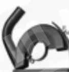
Ochranný kryt odsávání s vodícími saněmi pro rozbrušovací kotouče Ø 230 mm, řezná hloubka 65 mm, připojení Ø 32 mm
